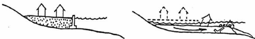
شکل ۴-۳ نمونه‌ای از نحوه جابه‌جایی افقی زمین در اثر گسترش جانبی ناشی از روانگرایی در پشت دیواره ساحلی
