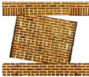
ب) مود شکست بر اثر حرکت گهواره‌ای
