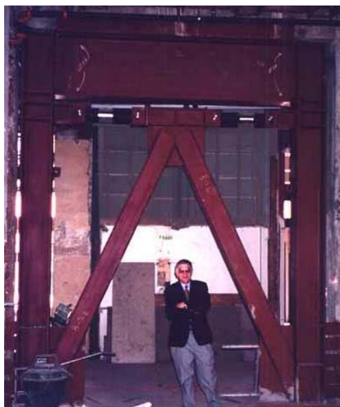
شکل ۷-۱۸- استفاده از میراگرهای ویسکوز در بادبندهای جناقی
