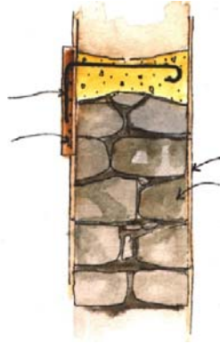
شکل ۹-۱۰ گل میخ‌های برشی برای نصب تسمه لرزه‌ای
