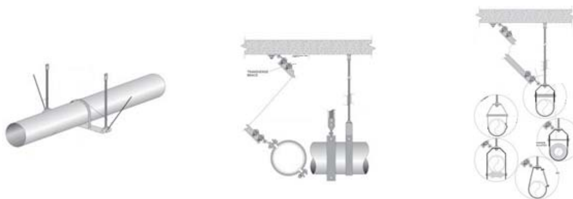
شکل ۱۰-۲۱- مهارهای جانبی برای لوله‌ها
